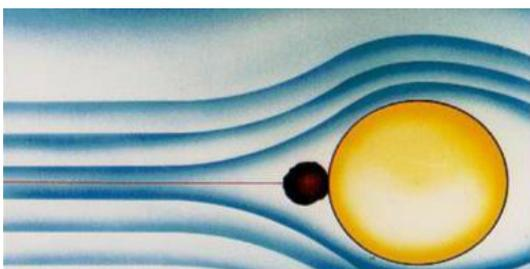
**惯性效应** 较大的灰尘粒子在气流中做惯性运动，当气流绕过纤维时，惯性大的离子来不及绕过而直接撞在纤维上。灰尘越大，惯性力越强，撞击纤维的可能性越大。
